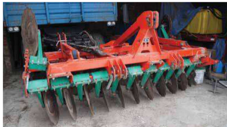
Według producenta, trzymetrowa brona talerzowa Agro-Masz BT30 wymaga 100 koni. A w gospodarstwie Ryszarda Koperniaka poradził sobie z nią 75-konny Zetor Major osiągając przy tym niskie spalanie paliwa na poziomie około 8 l/ha
